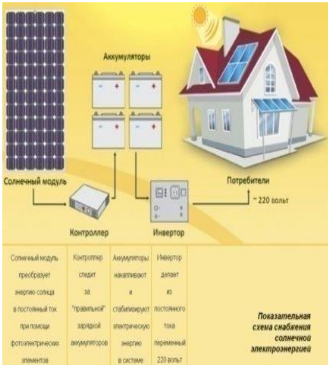
Рис. 3. Показательная схема снабжения солнечной электроэнергией
