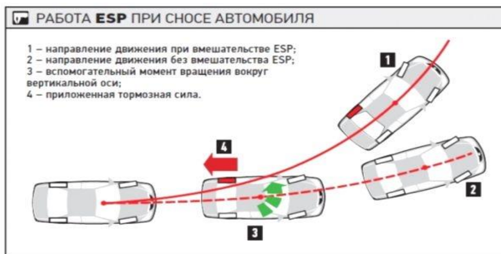
Рисунок 3 - Принцип работы системы курсовой устойчивости
