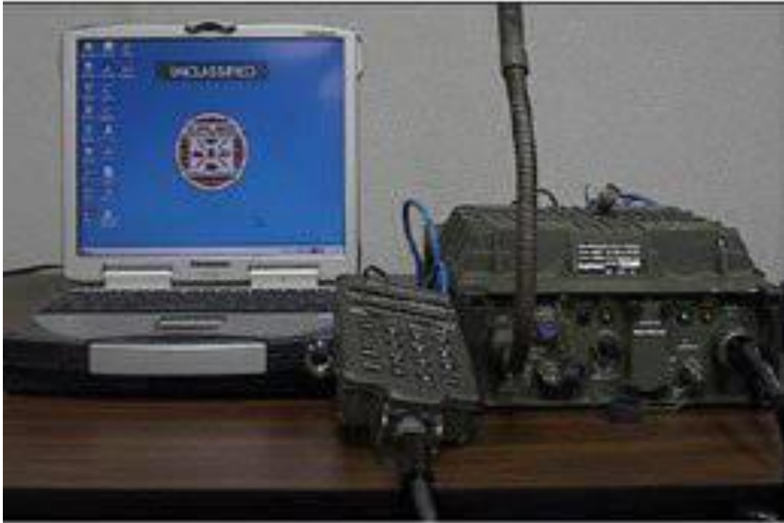
Рисунок 2 - Терминал системы «EPLRS» с подключенным ноутбуком
