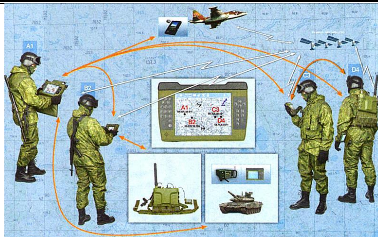
Рисунок 3. – Средства автоматизации (навигационно-связные терминалы) объединенные в локальные вычислительные сети
