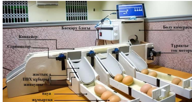
Сурет 5. – Жұмыртқаны жинауға және сұрыптауға арналған машинаның жұмыс принципі [7]
